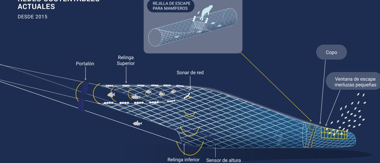
VISTA FRONTAL 80 m Sonar de red 20 m Sensor de altura
